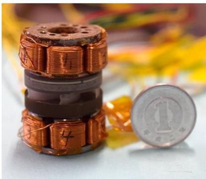
図 1 製作した改良型磁気浮上モータ
